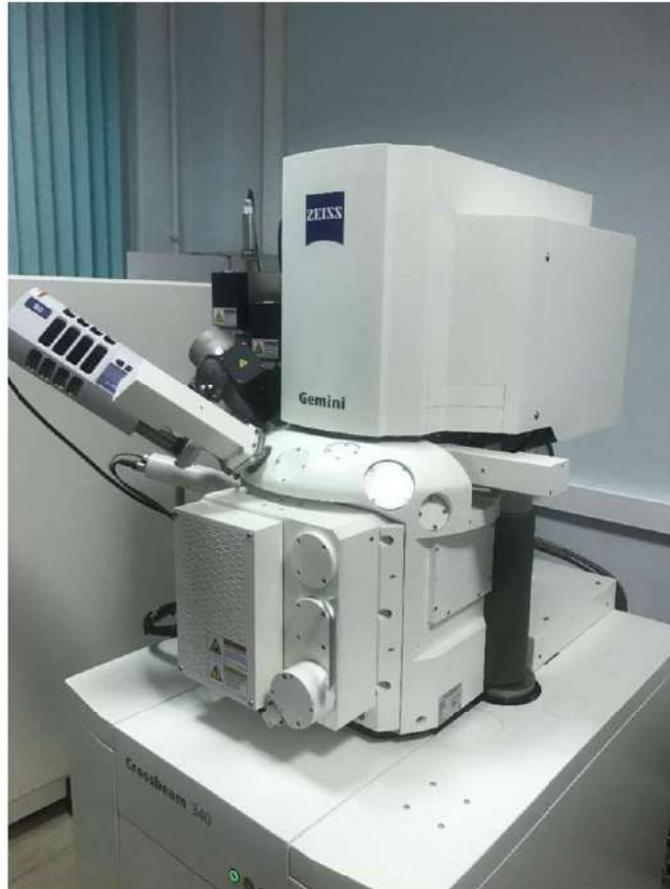
Рисунок С.1 – Двухлучевой сканирующий электронный/ионный микроскоп ZEISS CrossBeam 340 [304]
