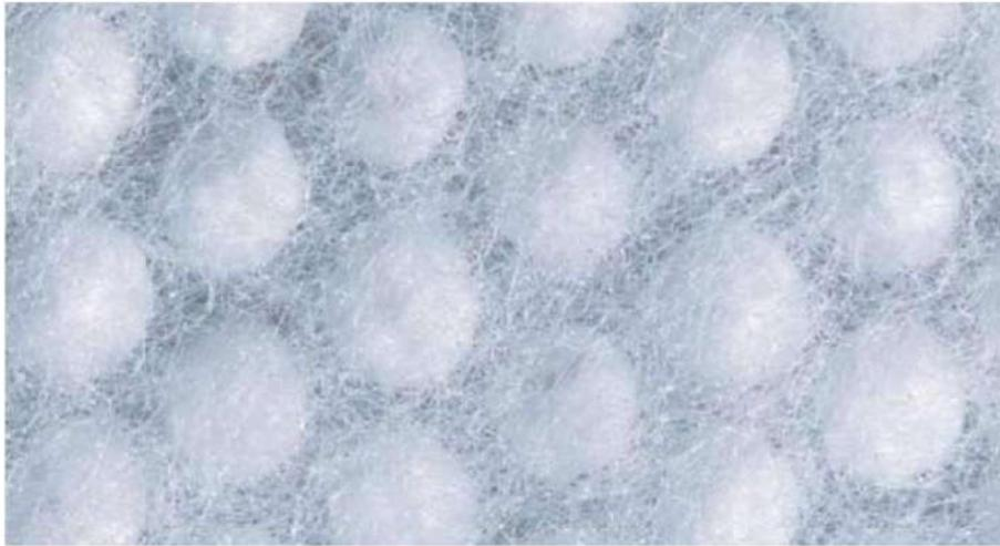
Рисунок Ж.3 – Структура микрокапсулированного нетканого полотна по технологии Schoeller®-PCM [283]
