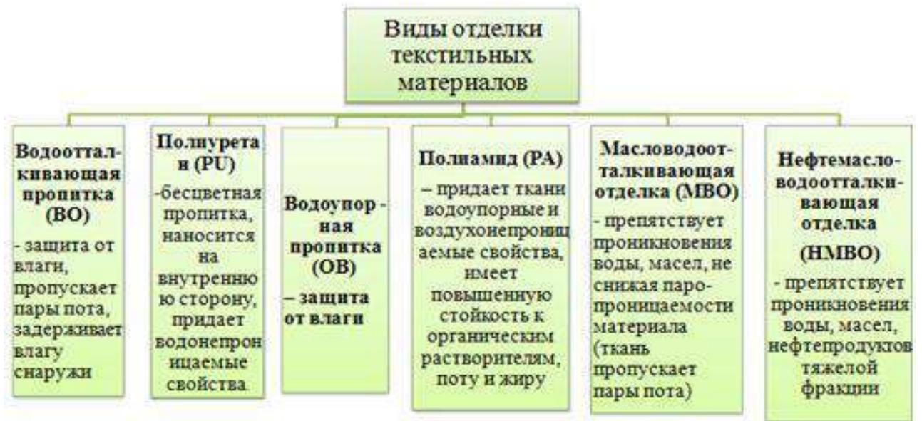
Рисунок 18 – Виды отделки для материалов специального назначения, используемые в условиях отрицательных температур
