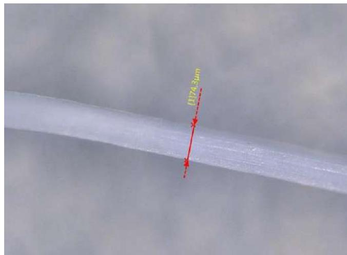
б) - микроструктурный анализ фторопластового волокна (увеличение 300х), диаметр 74,3мкм
